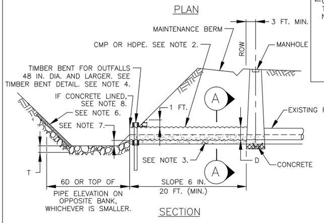
TYPICAL STORM SEWER OUTFALL STRUCTURE LAYOUT
